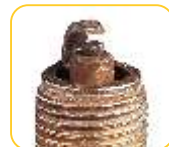
Eletrodos Arredondados : Fim de vida útil
