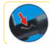
Trincado por Fuga de Corrente
