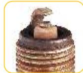
Eletrodos com desgaste excessivo: Risco de danos graves
