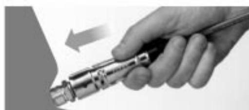
**IMPORTANTE:** Quando tiver que remover os cabos por alguma eventualidade, deve-se puxá-los pelos terminais, nunca pelos próprios cabos. Não utilize ferramentas para remover os cabos de ignição.
