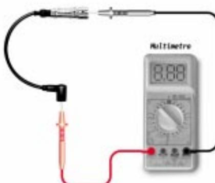
Para efetuar o teste em cabos de ignição novos ou usados, deve-se utilizar um multímetro ou ohmímetro. Medir o valor de resistência ôhmica entre os terminais do cabo. O valor encontrado
