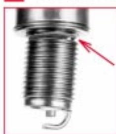
Aplicação excessiva do torque de aperto pode danificar a vela de ignição.
