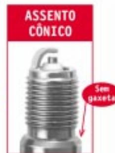
Aperte a vela de ignição com a mão até que a gaxeta encoste no cabeçote. Em seguida, aperte com a chave de vela adequada aplicando o torque especificado na tabela. A falta de aperto pode causar a pré-ignição, porque não há dissipação de calor. Por outro lado, o aperto excessivo pode danificar a rosca do cabeçote e da vela de ignição.
