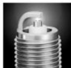
O teste de centelhamento deve ser realizado com um aparelho que simule as condições da vela no motor, ou seja, aplicação de alta voltagem (25 KV) e pressão de gás entre os eletrodos de até  $8 \text{ kgf/cm}^2$ . Nestas condições o centelhamento entre os eletrodos deve ser uniforme e sem ocorrência de fuga pelo isolador.
