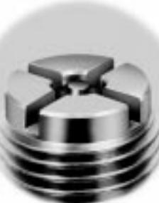
A foto acima mostra uma vela projetada para motores rotativos. Nesses motores as velas de ignição estão sujeitas a um aquecimento maior devido a isto os eletrodos são mais robustos, e com esta configuração proporcionam menor desgaste.
