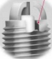
Este tipo de vela possui um Gap suplementar, o qual diminui a possibilidade de falhas de ignição. O pequeno espaço entre o Gap suplementar e o isolador dificulta entrada de gases ricos em carbono, reduzindo o acúmulo de carvão sobre o isolador.
