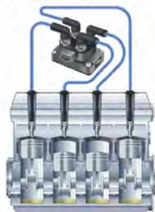
**U3** - Bobina com duas saídas alimentando os cilindros gêmeos. Necessário o uso de duas Bobinas.
