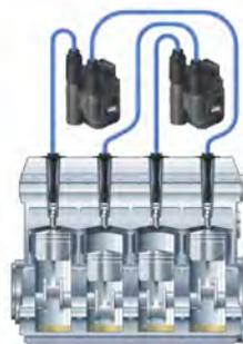
**U4** - Bobina tipo top coil e/ou pencil (caneta) com duas saídas alimentando os cilindros gêmeos. Necessário o uso de duas bobinas. Necessário o uso de duas Bobinas.
