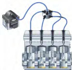
**U2** - Bobina com 4 torres de saída 2X2, onde tem os cilindros gêmeos. Duas saídas alimentam os cilindros 1 e 4 e as outras duas alimentam os cilindros 2 e 3.
